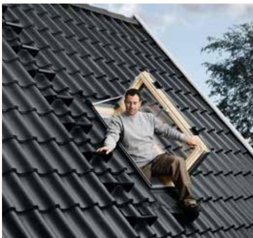
Мансардное окно и одновременно выход на крышу для отапливаемых помещений. Открывается по боковой оси, удобно для обслуживания кровли. Газовая пружина в верхней части оконной створки облегчает ее открывание. Изготовлено из клееной древесины, лаковое покрытие.
