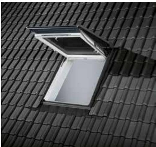
Мансардное окно со всеми характеристиками и функциями окна GPL и одновременно аварийный выход на крышу. При нажатии ручки для аварийного выхода окно автоматически открывается газовыми пружинами. Подходит для всех отапливаемых мансардных помещений. Увеличенный угол открывания – 67°. Изготовлено из клееной древесины, лаковое покрытие. Размеры аварийного выхода при 67°:
